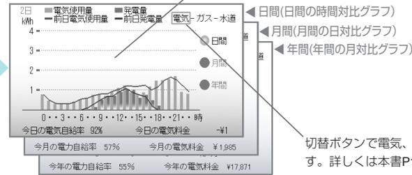
日間、月間、年間の使用量（電気の場合は発電量も）を棒グラフと折れ線グラフで表示します。
