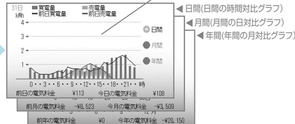
日間、月間、年間の買電量、売電量（電気料金）を棒グラフと折れ線グラフで表示します。
